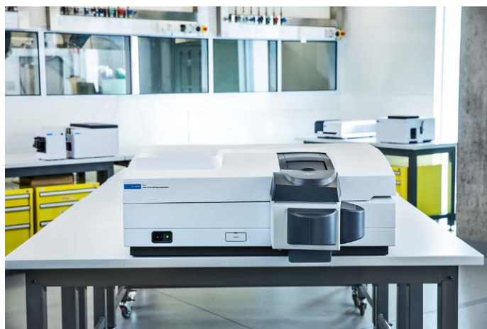
图 3. 配备外置 DRA 积分球的 Agilent Cary 5000 UV-Vis-NIR 分光光度计
